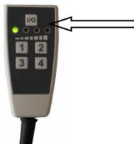
a) Durch erneutes Betätigen der I/O-Taste wird der Unterdruck abgeschaltet. Anschließend wird automatisch ausgeblasen.
